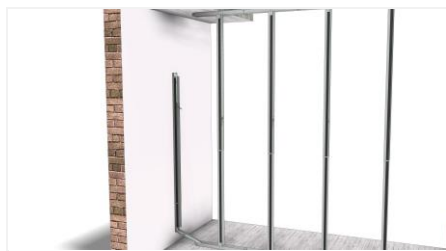
Klap de horizontale profielen uit.
